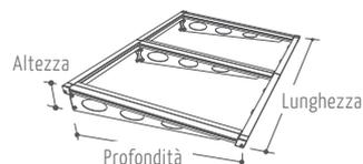
Struttura piana con mensola in acciaio ideale per applicazioni che necessitano di un ingombro ridotto in altezza, per la protezione di ingressi, porte, finestre nelle costruzioni moderne. Altezza variabile da 370-700mm, a seconda della dimensione.
