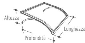
Struttura curva ad arco ribassato, con mensola in tubolare, ideale per applicazioni che necessitano di una portata elevata, per la protezione di porte, portoni e camminamenti. Il particolare attacco a muro separato dalla banchina garantisce il perfetto allineamento dei moduli anche in presenza di murature irregolari e la realizzazione di coperture con profondità fino a 2.250mm.
